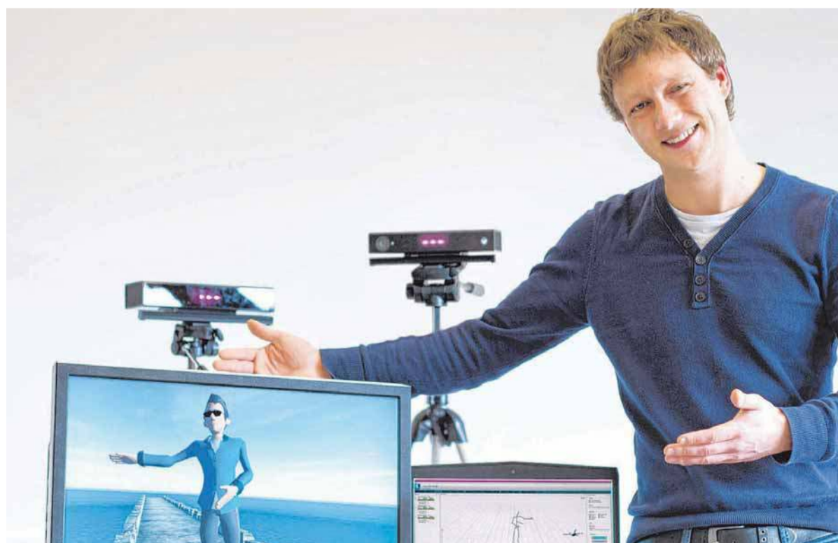
Medieninformatiker Michael Rietzler demonstriert die Arbeitsweise des „FusionKit“. Mit Hilfe einer speziell entwickelten Software und handelsüblicher Kinect-Kameras können die Bewegungen von Menschen in Echtzeit durch den Computer erfasst werden. Ein Datenanruf ist überflüssig.
